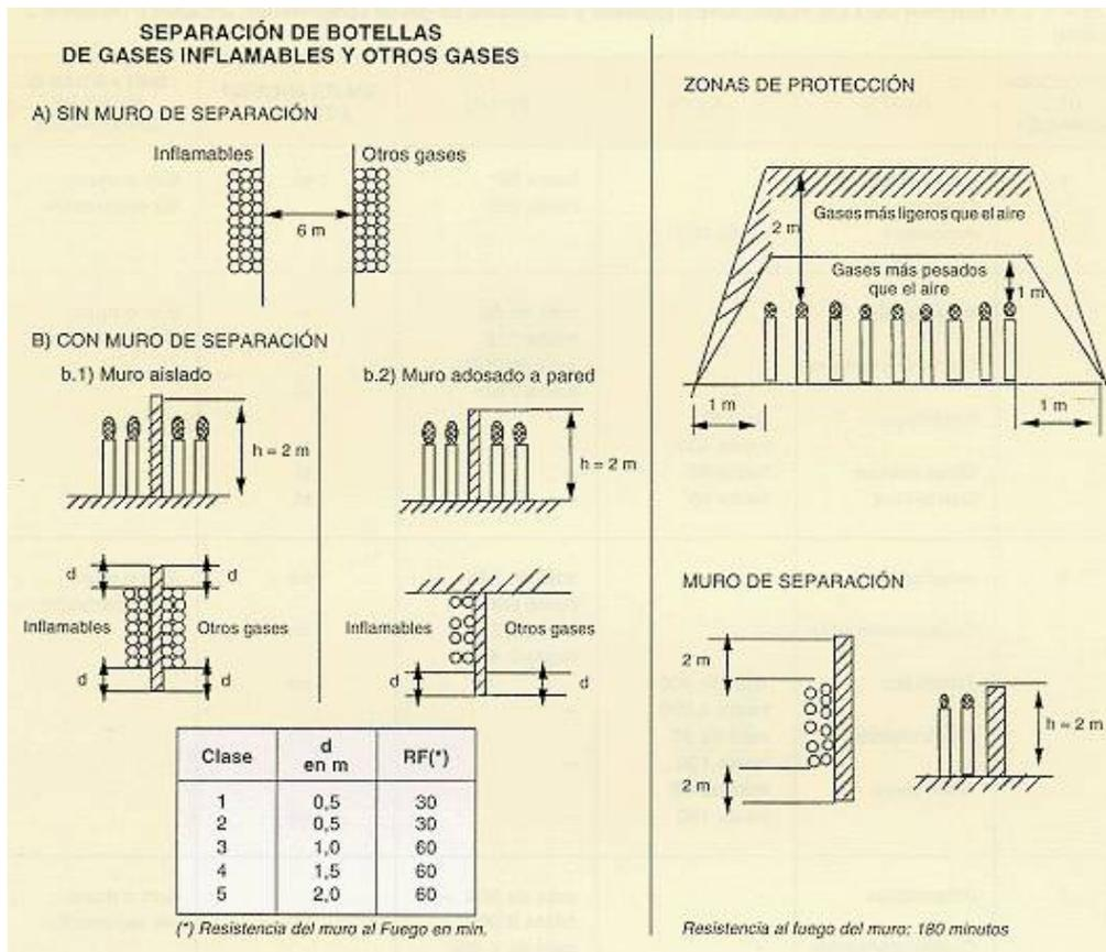
**Fig. 1: Almacenamiento de gases licuados en recipientes móviles**
